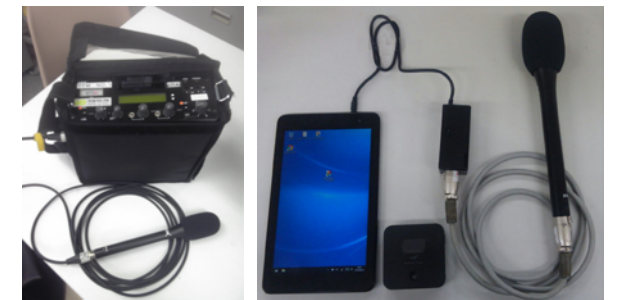
左/通常の中継に使用している機材 右/IP音声伝送システム・機材例
